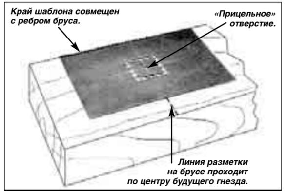
Теперь, когда шаблон готов, приступим к работе. Сначала с помощью рулетки отметим на балке по всей ее длине карандашом места центров будущих гнезд. Затем приложим к первой метке наш шаблон так, чтобы его «прицельное» отверстие совпало с карандашной меткой, а край шаблона — с ребром (см. рисунок).
